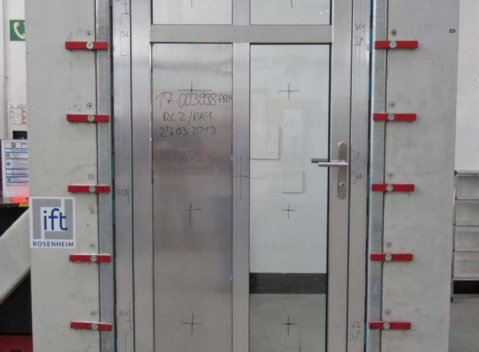
↑ Am Prüfstand untersucht das Institut für Fenstertechnik (ift) Rosenheim die Einbruchsicherheit von Haustüren.
