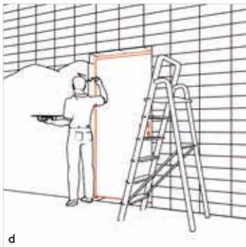
Alle Arbeiten der nassen Bauphase (Estrich, Verputzen, Elektrik, Trockenbau etc.) werden abgeschlossen.
