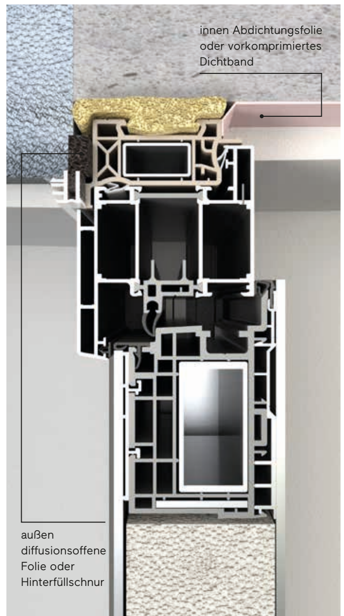
Zweistufige Montage mit Zarge
