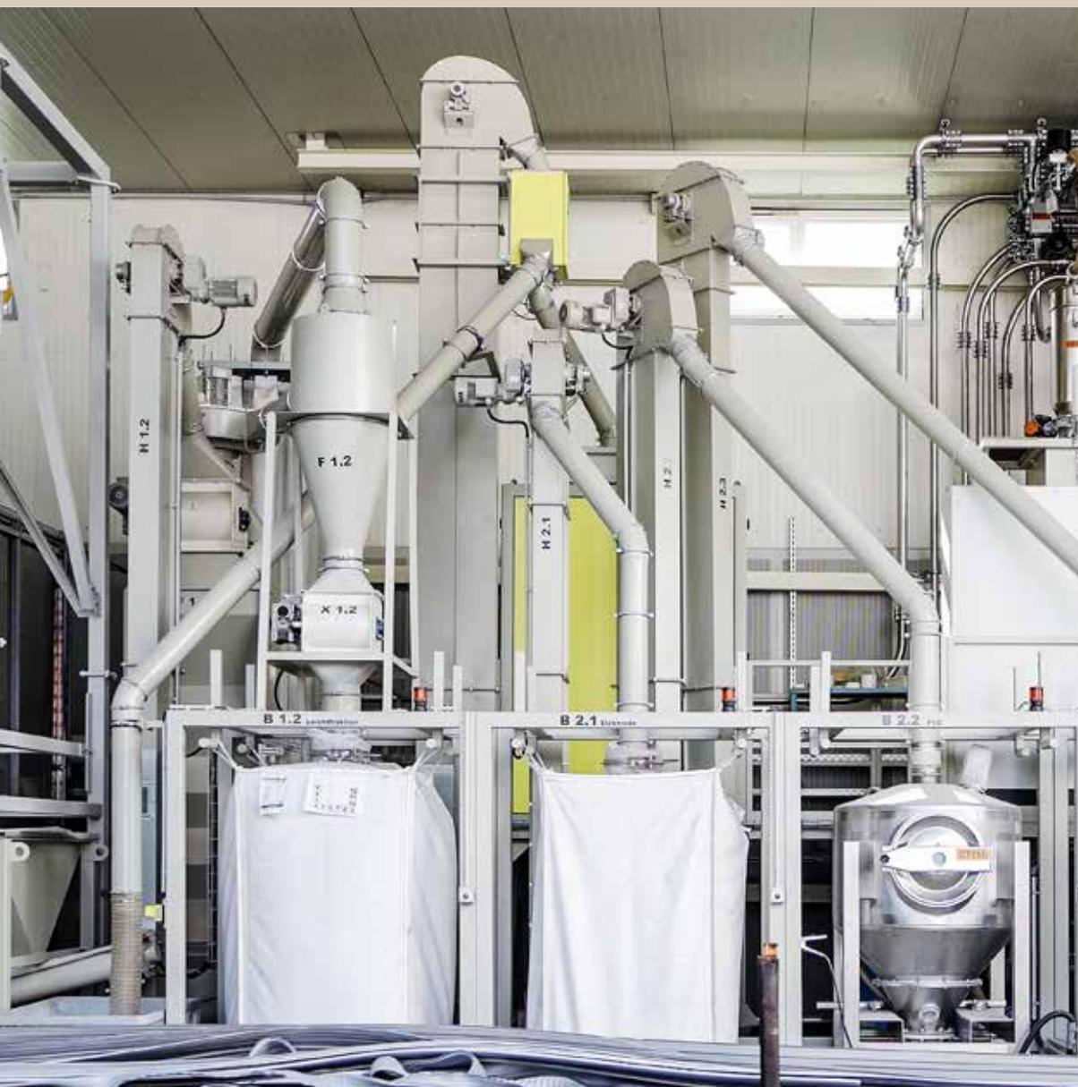
A unidade moderna de reciclagem permite reutilizar internamente os restos e recortes dos perfis de PVC fabricados.
