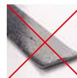
O PVC de cor escura aquece rapidamente e torna-se maleável a partir de uma temperatura inferior a 80 °C, deformando-se.
