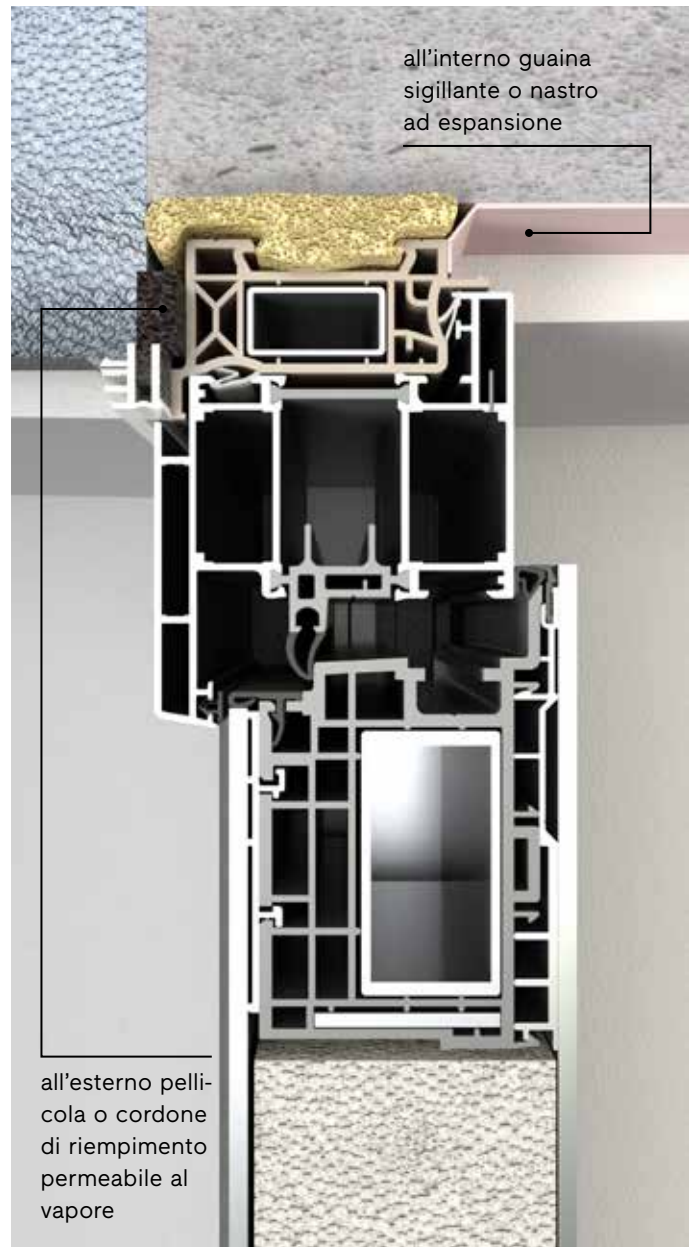
Posa in due fasi con controtelaio
