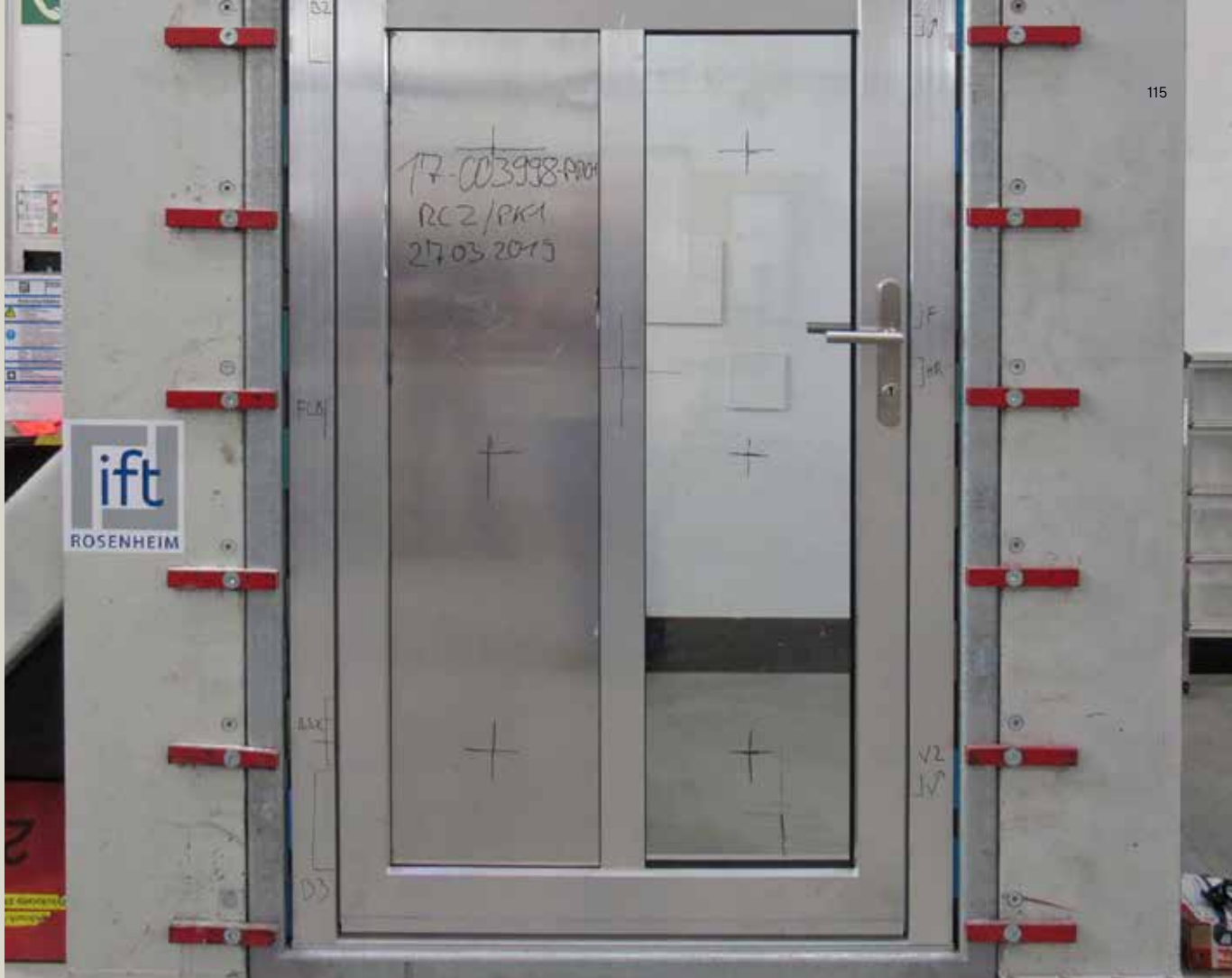
Al banco di prova l'Istituto ift di Rosenheim verifica la sicurezza antieffrazione delle porte d'ingresso.
