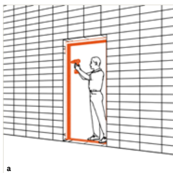
a Inseriamo e fissiamo il nuovo telaio alla muratura nella fase di costruzione al grezzo.
