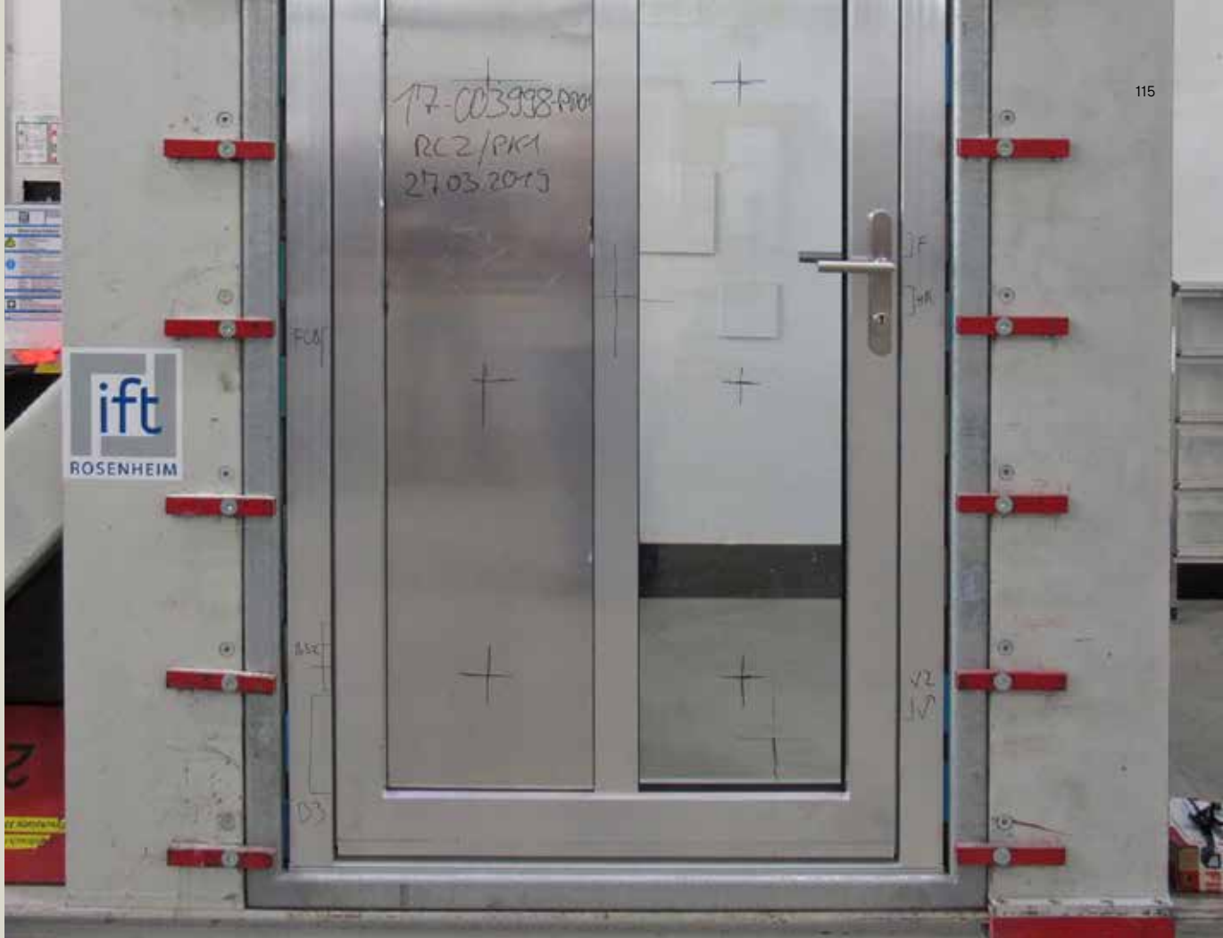
En el banco de pruebas, el Instituto ift de Rosenheim comprueba la resistencia antirrobo de las puertas de entrada.
