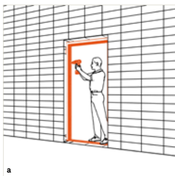
a Fijación del nuevo marco al muro en fase de construcción.
