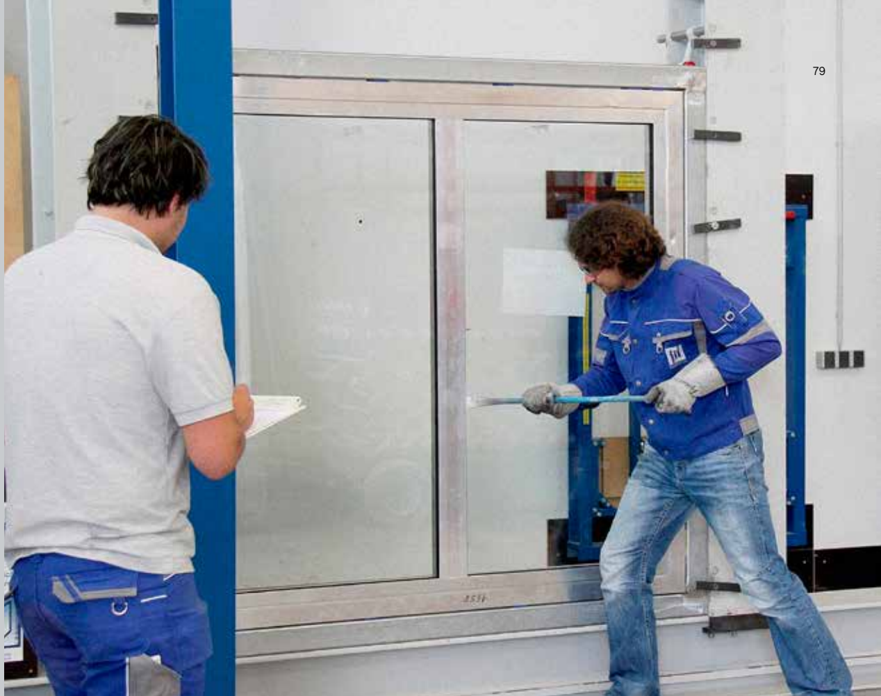
En el banco de pruebas, el Instituto ift de Rosenheim comprueba la resistencia antirrobo de las ventanas.
