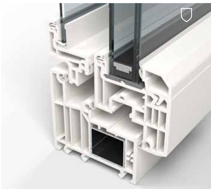
Sección de una ventana con hoja combinada Twin y vidrio interior laminado de seguridad Multiprotect, composición 33.1v-20-4T/6F0
