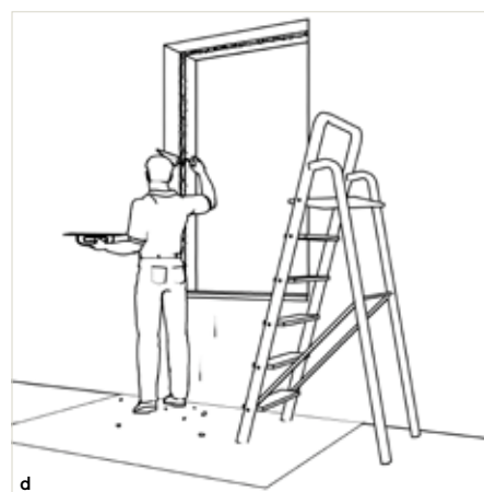
El muro se repara por el exterior y el interior (enlucido y pintura). Si es necesario se monta un pequeño andamio.
