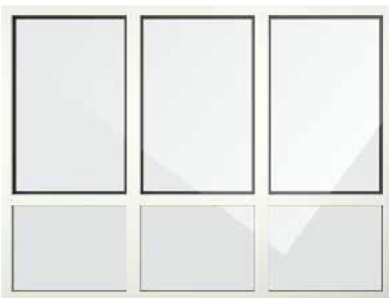
zesdelige raamwand met drie profielloze vleugels bovenaan en drie velden vaste beglazing onderaan
