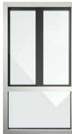
onderlicht in vorm van vast veld met tweevleugelig, profielloos raam en met glas overdekt middendeel (type 402)
